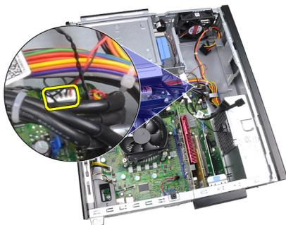
4. Svitare il cavo dell'altoparlante dalla clip del telaio.
