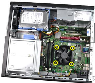
5. Sollevare il gruppo dissipatore di calore verso l'alto e rimuoverlo dal computer. Collocare il gruppo con la ventola rivolta verso il basso e con il lubrificante termico rivolto verso l'alto.
