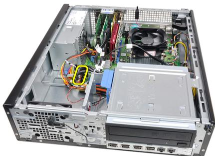
5. Rimuovere la vite che fissa il pannello di Input/Output al telaio.
