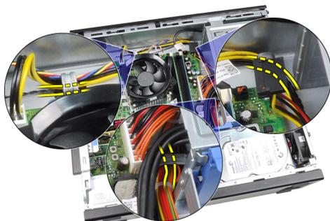
6. Svitare il cavo del sensore termico dalla clip del telaio.
