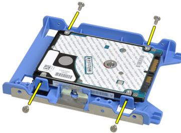
8. Allentare le viti che fissano il disco rigido da 2,5" alla parte superiore del supporto del disco rigido.
