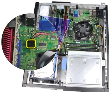
4. Far scorrere l'interruttore di apertura verso la parte inferiore della scheda di sistema e rimuoverlo.
