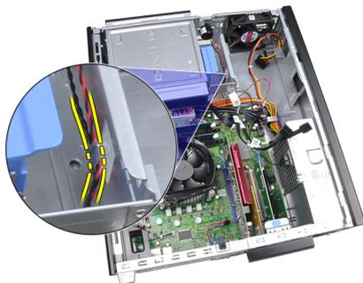
5. Premere la linguetta di blocco dell'altoparlante e far scorrere l'altoparlante verso l'alto per rimuoverlo.
