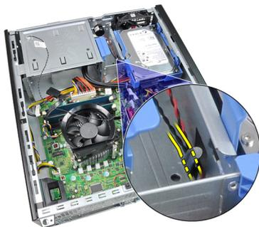
7. Fare leva sul sensore termico per allontanarlo dalla parte anteriore del telaio e rimuoverlo.
